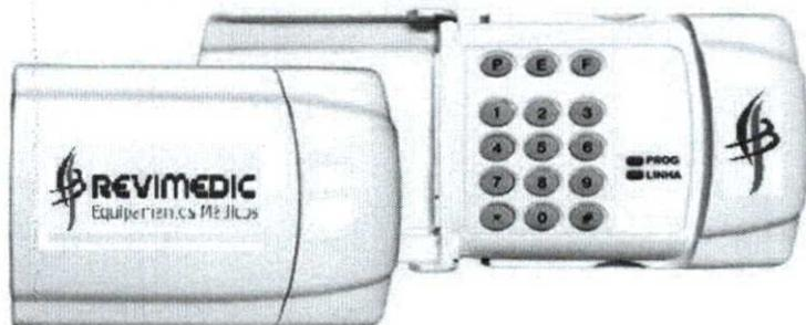
O tele alarme funciona através de uma linha telefônica. Faz ligações para os números registrados quando a temperatura sair faixa programada, ou se a tensão da bateria estiver baixa. Para que o discador funcione, é necessário conectar um cabo telefônico.
